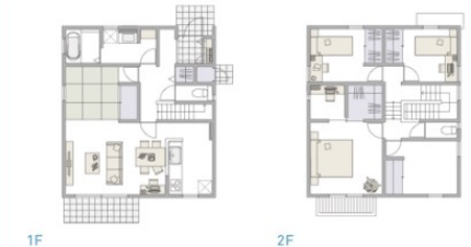
36-2NE-1 間口(東西)／7.2m 奥行(南北)／8.1m 建築面積／59㎡ 延床面積／118㎡ 1F床面積／58㎡ 2F床面積／59㎡
